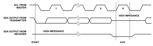
FIGURE 18. ACKNOWLEDGE RESPONSE FROM RECEIVER
