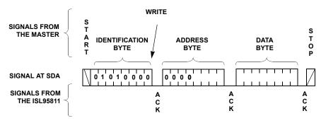
FIGURE 19. BYTE WRITE SEQUENCE
