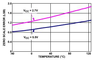
FIGURE 7. ZSerror vs TEMPERATURE
